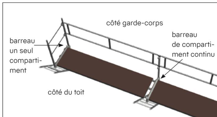
**Compartiments continus** : Chaque console d'échelle de toit repose sur sa propre échelle de toit.
