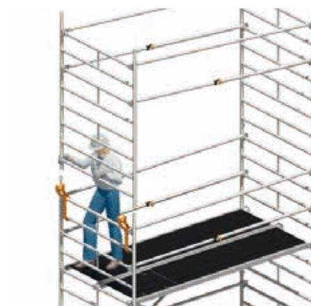
Après avoir installé l'élément de cadre, les plateformes et les diagonales, le niveau de plancher suivant peut être accessible en toute sécurité..
