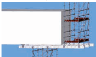
FlexBeam en porte-à-faux autour d'un objet
