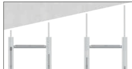
Les poutres d'insertion permettent d'ajuster facilement les zones de bord grâce à différentes longueurs d'extension.
