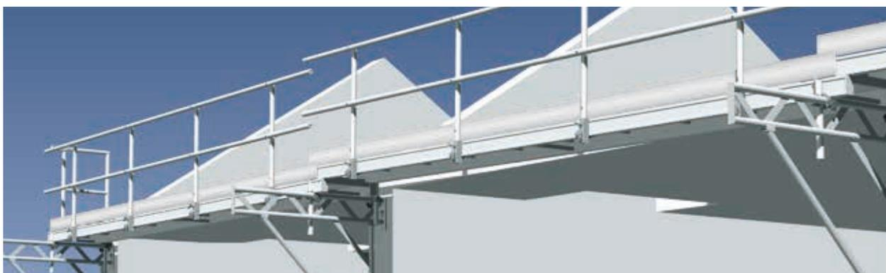
Dans la construction résidentielle (construction en briques coulées ou silico-calcaires), un ou deux passerelles de travail peuvent être placés les uns à côté des autres sur des consoles universelles en aluminium Layher. Cela crée rapidement et facilement un plancher de travail, un plancher de protection contre les chutes ou une plate-forme de circulation. Installation en construction coulée sur des agencements de douille filetée M20 à préfabriquer.
