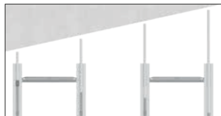
Met de tussendragers kunnen de randzones gemakkelijk worden aangepast dankzij verschillende uitschuiflengtes
