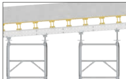
Gebruik van schuine vloerbekisting
