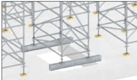
Overbrugging in het basisgebied
